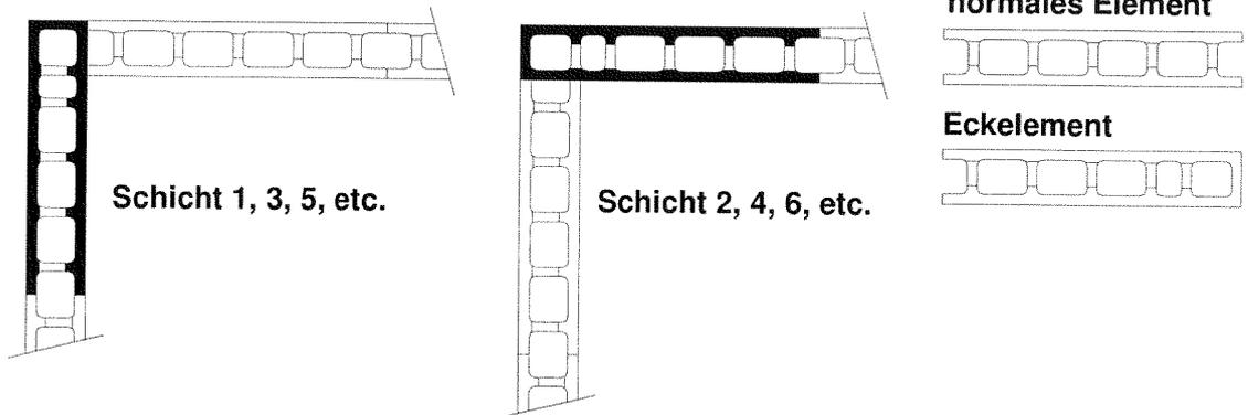
**Schichtaufbau in der Wandecke – Typen TW 30, TW 32, TW 35**
