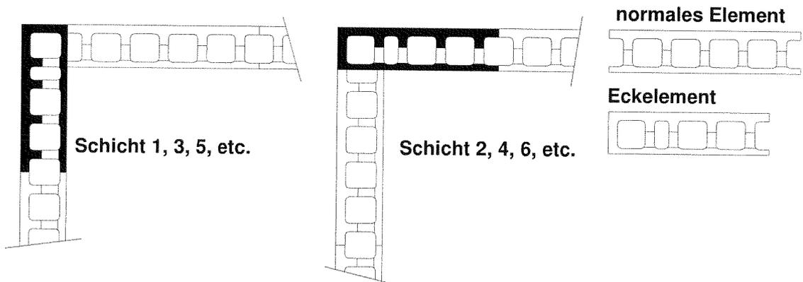
**Schichtaufbau in der Wandecke – Typen S 25/6, S 30/5, S 30/7, S 30/9, S 32/11**
