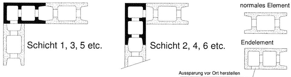
Schichtaufbau in der Wandecke – Typ Ds25/12, DM25/16 und DSs25/12
