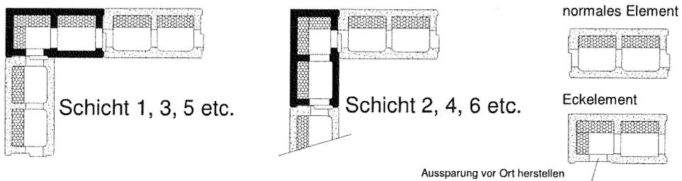
Schichtaufbau in der Wandecke – alle Typen mit einer Dicke von 30 cm
