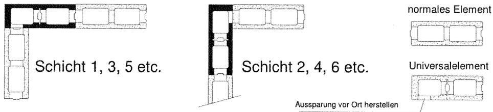
Schichtaufbau in der Wandecke – Typ DMi20/13 und DM22/15
