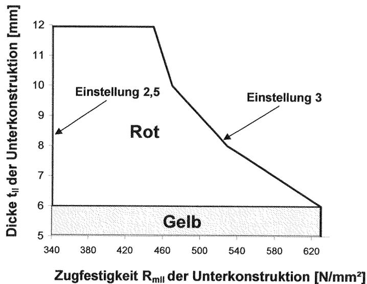
Vorgehen zur Ermittlung der optimalen Setzenergieeinstellung am Setzgerät Hilti DX 450 (125%):
