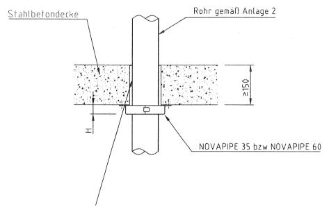
Fugenverschluss mit Beton, Zementmörtel oder Gipsmörtel; wahlweise bei Fugen-breiten≤10mm mit Mineralwolle (Baustoff-klasse DIN 4102-A; Schmelzpunkt >1000°C) fest ausgestopft.
