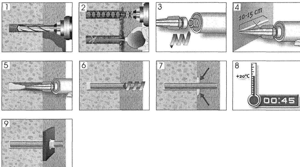
MUNGO Injektionssystem MIT-SV mit Ankerstange A4
