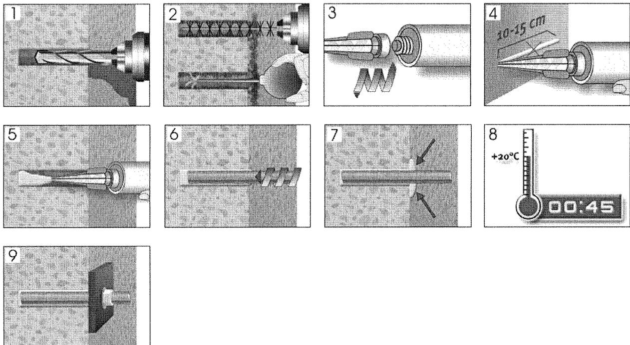
MUNGO Injektionssystem MIT-SV mit Ankerstange SVZ
