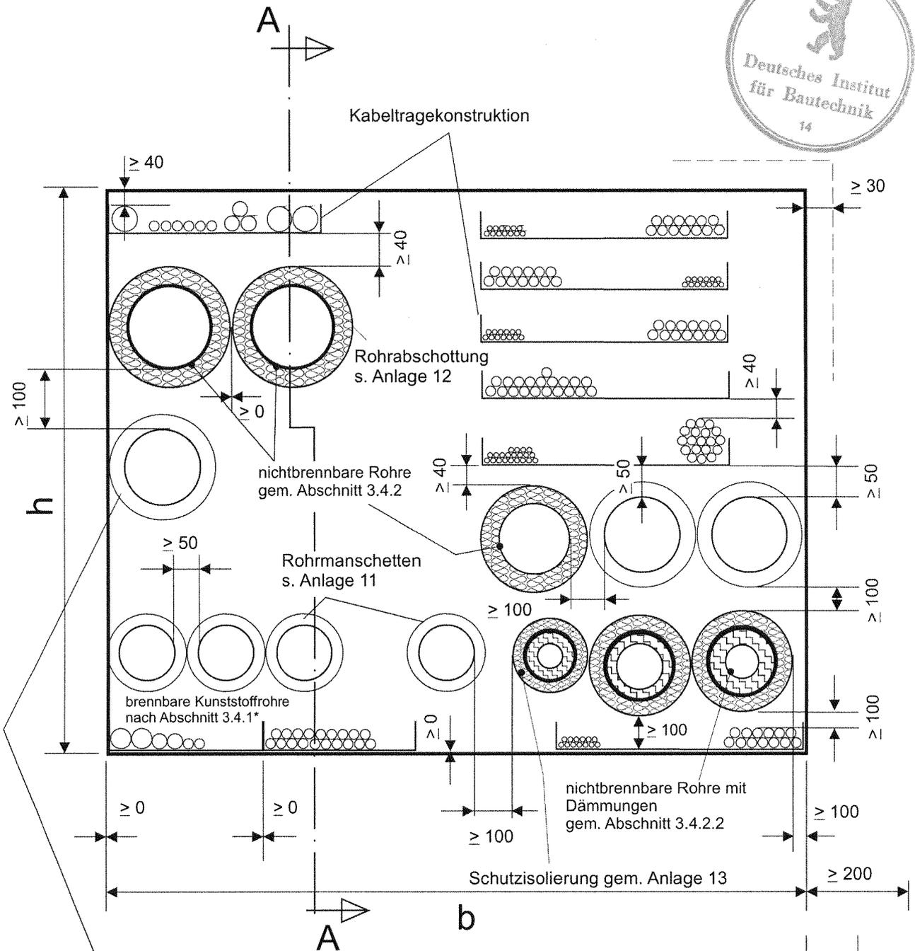
Die Manschetten bzw. Befestigungslaschen dürfen nur bei Manschetten nach der allg. bauaufsichtl. Zulassung Nr. Z-19.17-1194 über die Schottflächen hinausragen.
