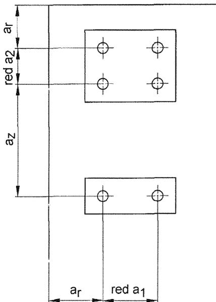
Reduzierte zulässige Lasten bei reduzierten Achsabständen je Dübel, bei Dübelgruppen mit  $min a \leq red a < a$  (siehe Abschnitt 3.2.2.1).
