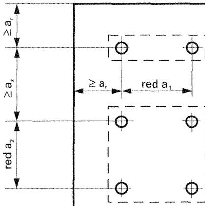
Reduzierte zulässige Lasten bei reduzierten Achsabständen je Dübel bei Dübelgruppen min  $a \leq \text{red } a \leq a$  (siehe Abschnitt 3.2.3.1)
