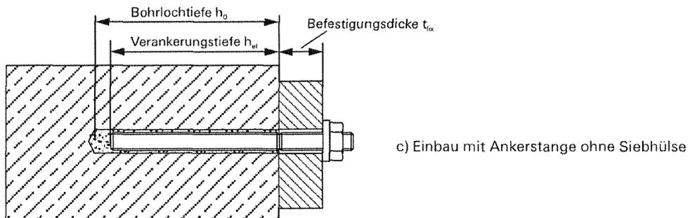
Dübel in eingebautem Zustand im Porenbeton
