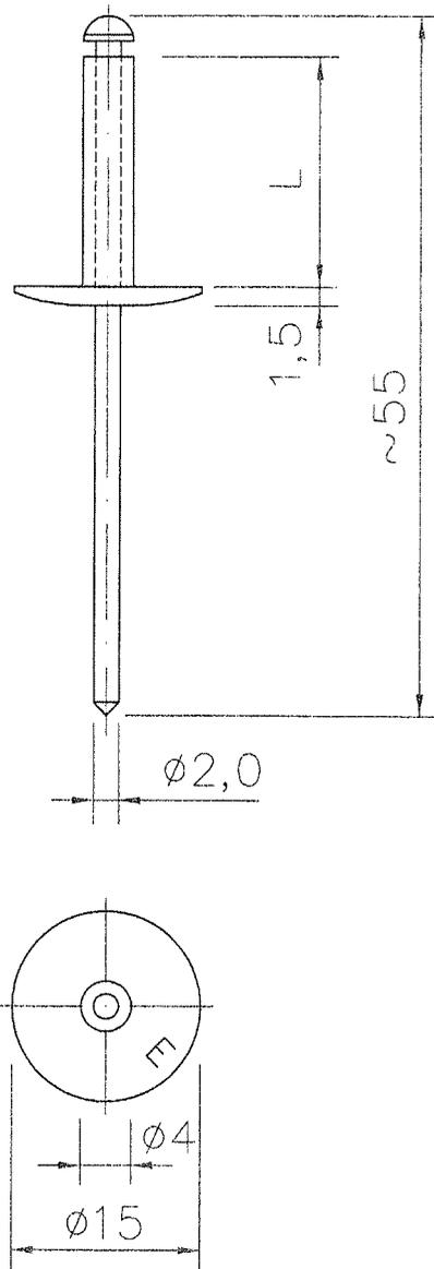
**Blindniet 4x18 mm, Kopf 15 mm für Plattendicke 6 mm und 8 mm**
