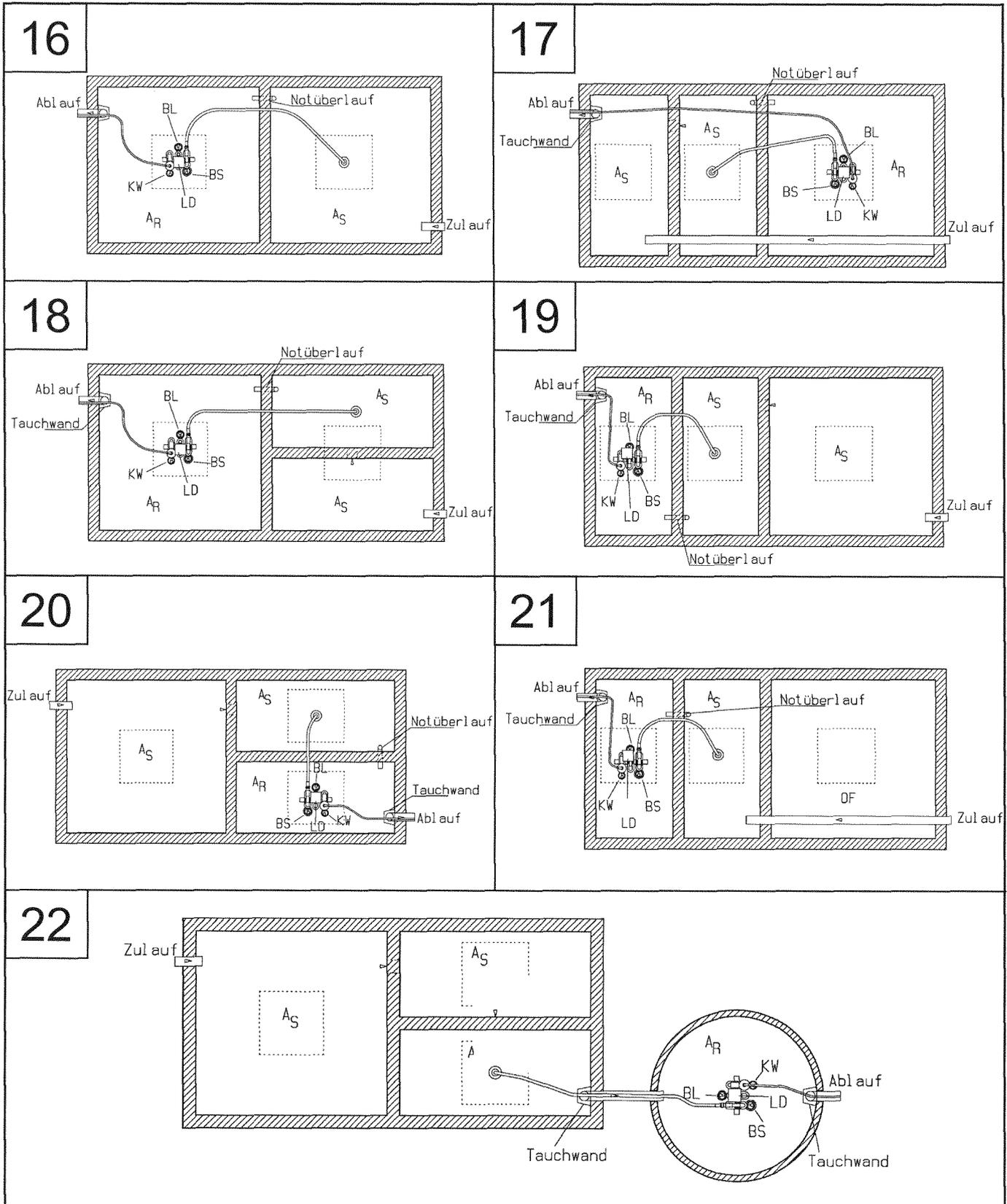
Abkürzungen: A<sub>S</sub> = Schlamm-speicher und Puffer, A<sub>R</sub> = Belebungsraum, OF = Ohne Funktion, KW = Klarwasserpumpe, BS = Beschickerpumpe, BL = Belüfter
