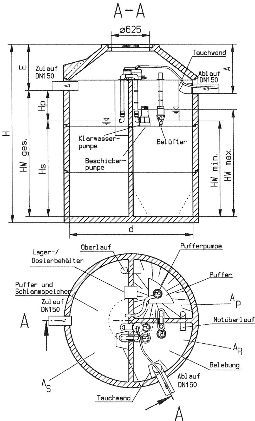
Alle Kammern können auch separate, in unterschiedlicher Form und Größe ausgebildete Behälter sein.
