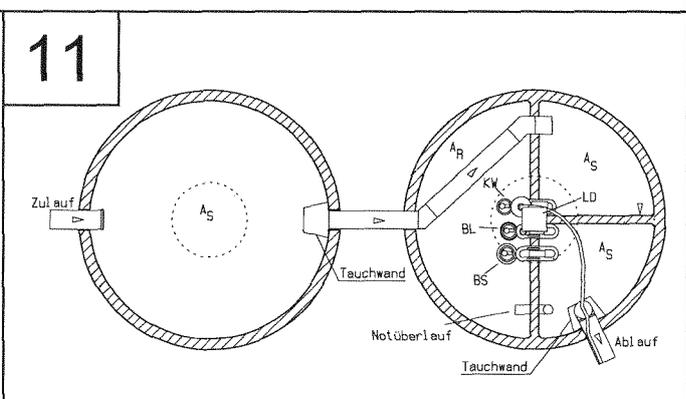
Abkürzungen: A<sub>S</sub> = Schlamm-speicher und Puffer, A<sub>R</sub> = Belebung, OF = Ohne Funktion, KW = Klarwasserpumpe, BS = Beschickerpumpe, BL = Belüfter
