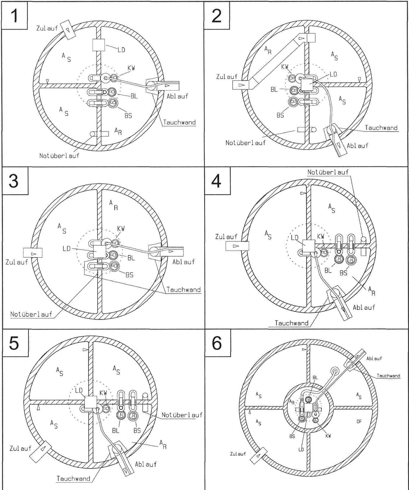
Abkürzungen: A<sub>S</sub> = Schlamm-speicher und Puffer, A<sub>R</sub> = Belebung, OF = Ohne Funktion, KW = Klarwasserpumpe, BS = Beschickerpumpe, BL = Belüfter
