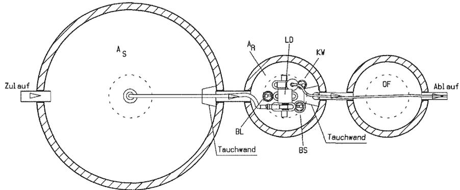
Abkürzungen: A<sub>S</sub> = Schlamm-speicher und Puffer, A<sub>R</sub> = Belebung, OF = Ohne Funktion, KW = Klarwasserpumpe, BS = Beschickerpumpe, BL = Belüfter
