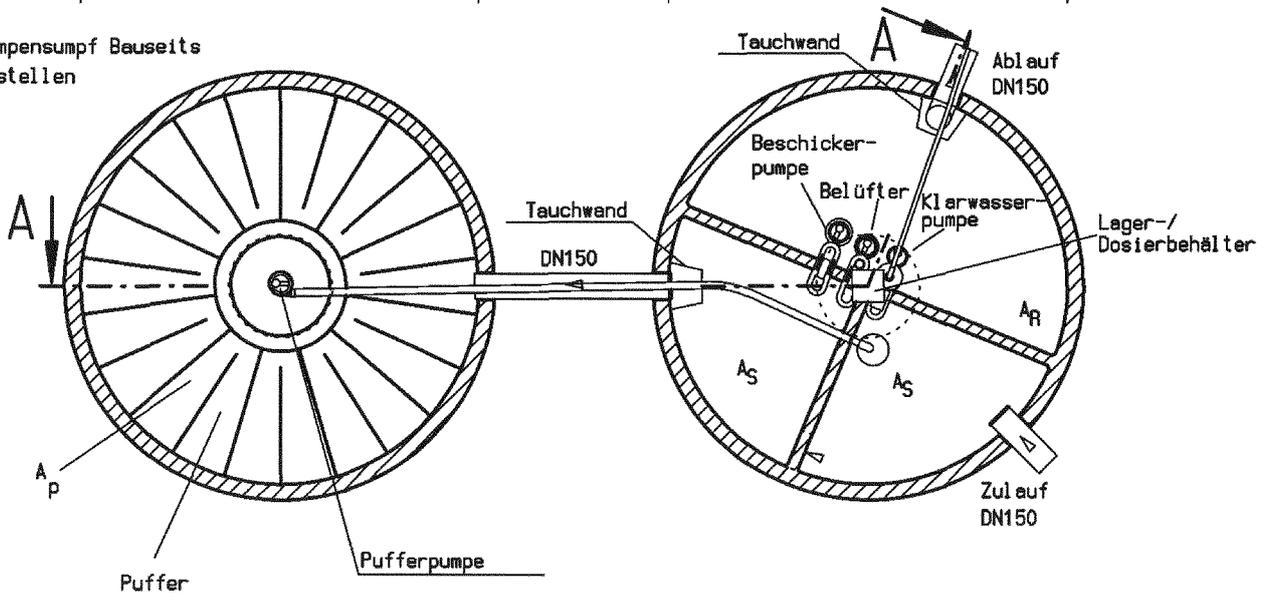
Alle Kammern können auch separate, in unterschiedlicher Form und Größe ausgebildete Behälter sein. Zu- und Abläufe der Nachrüstung sind der entsprechenden Ausführung anzupassen. Einzelne Kammern bzw. Behälter können, falls es sich aus der Klärtechnischen Berechnung ergibt, stillgelegt werden.
