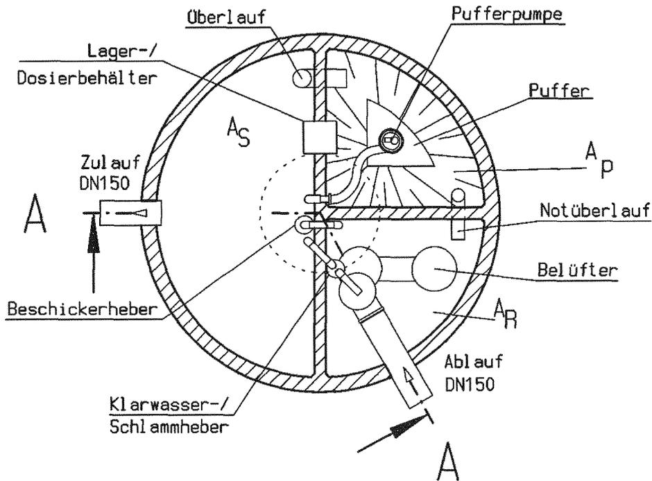
Alle Kammern können auch separate, in unterschiedlicher Form und Größe ausgebildete Behälter sein. Zu- und Abläufe der Nachrüstung sind der entsprechenden Ausführung anzupassen. Einzelne Kammern bzw. Behälter können, falls es sich aus der Klärtechnischen Berechnung ergibt, stillgelegt werden.
