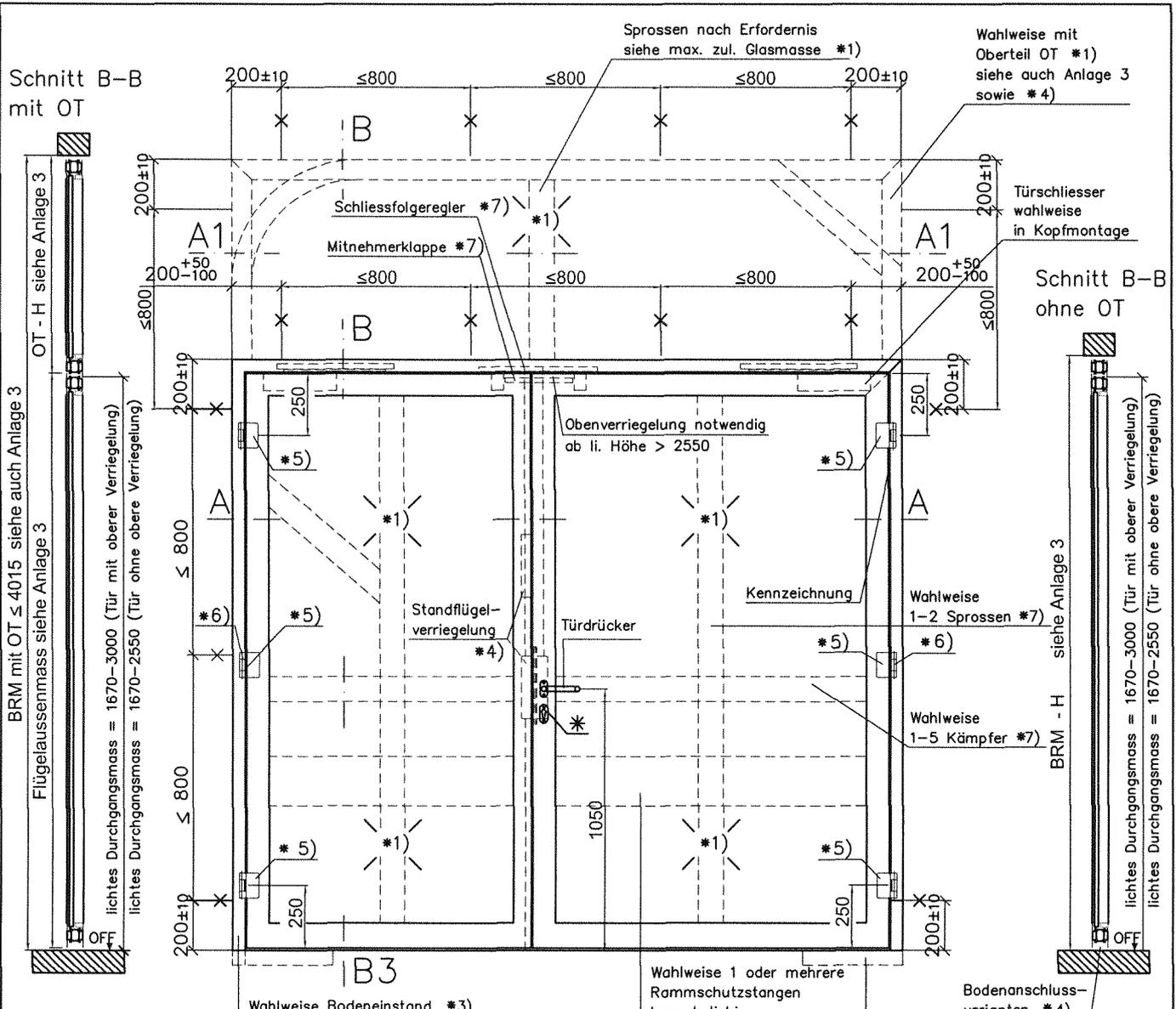
Zargenvarianten, -abmessungen, -verankerungen, -hinterfüllung; Kämpfer; Pfosten; Sprossen; Zubehöerteile: \*3)
