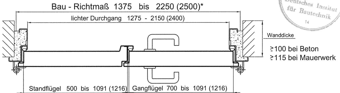
Zargenvarianten, -abmessungen, -verankerungen, -hinterfüllungen, Bodenanschlüsse, Zubehörteile siehe Einbauanleitung
