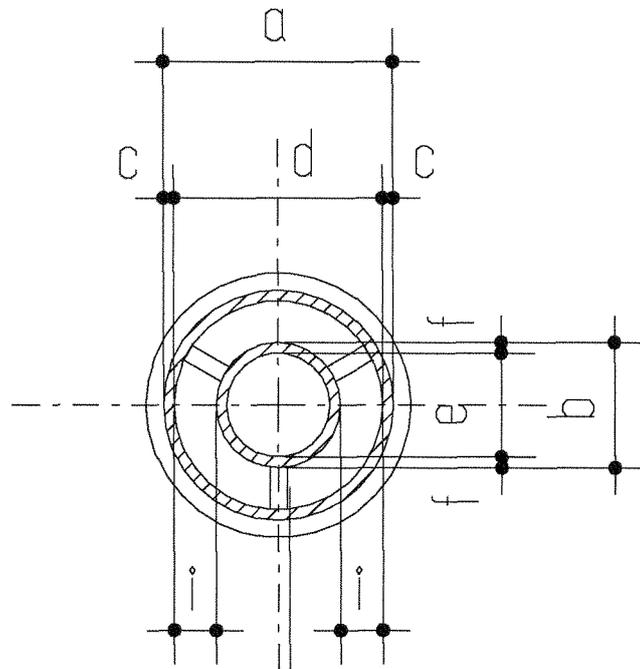
A = Querschnittsfläche für Zuluft
