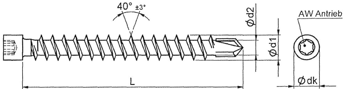
ASSY VG plus Holzschraube mit Zylinderkopf, Bohrspitze und Vollgewinde
