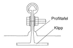
Schraube M6x25 mit Mutter und Scheibe mit aufvulkanisierter Dichtung
