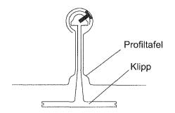
zugelassener Blindniet ø4,8x11 oder zugelassener Blindniet ø5x12 mit Kopfdurchmesser 8 bis 10 mm
