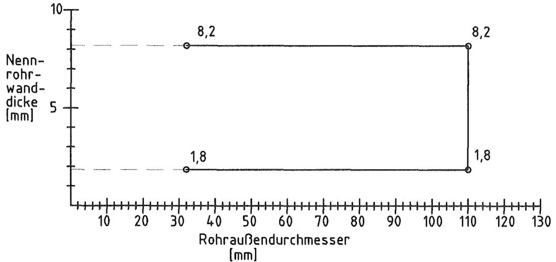
Einbau in leichte Trennwand,  $d \geq 100$  mm für Rohre gemäß Abschnitt 3.2.2 der Besonderen Bestimmungen der allgemeinen bauaufsichtlichen Zulassung
