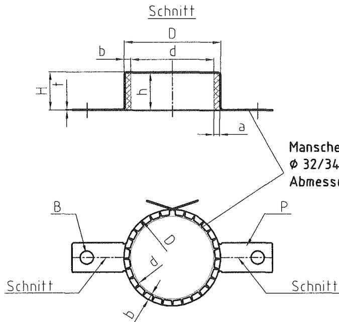
Manschetten passend zum  $\varnothing 32/34$  bis  $\varnothing 50/52$  mm
