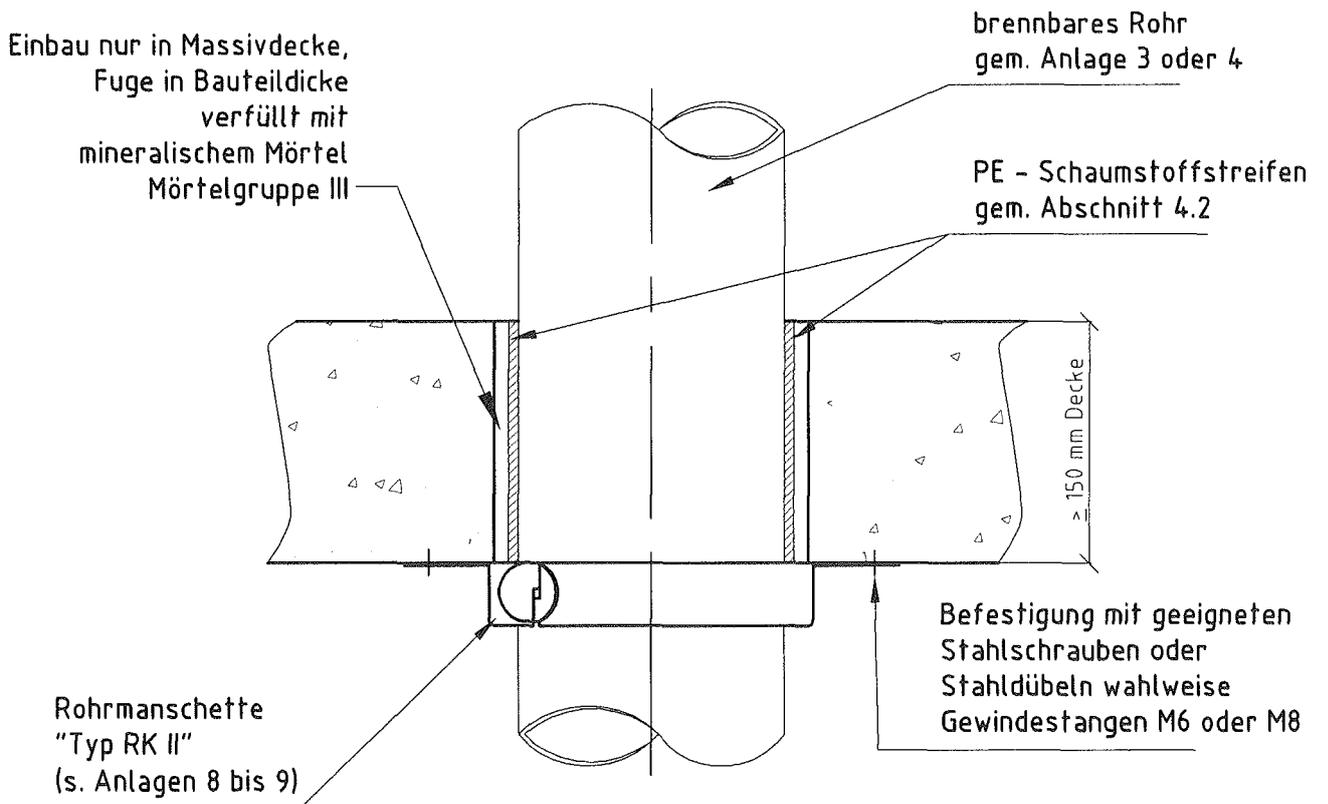
Rohrabschottung " Würth Rohrabschottung M leicht " der Feuerwiderstandsklasse R 90 nach DIN 4102-11
