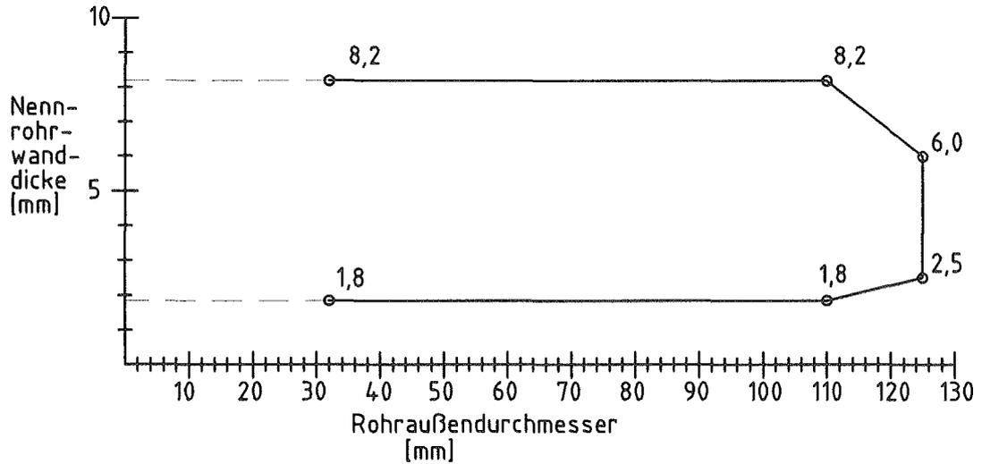
Einbau in Massivwand,  $d \geq 100$  mm für Rohre gemäß Abschnitt 3.2.2 der Besonderen Bestimmungen der allgemeinen bauaufsichtlichen Zulassung Abstand  $a = 0$  mm, Laschen eingegossen oder aufgesetzt
