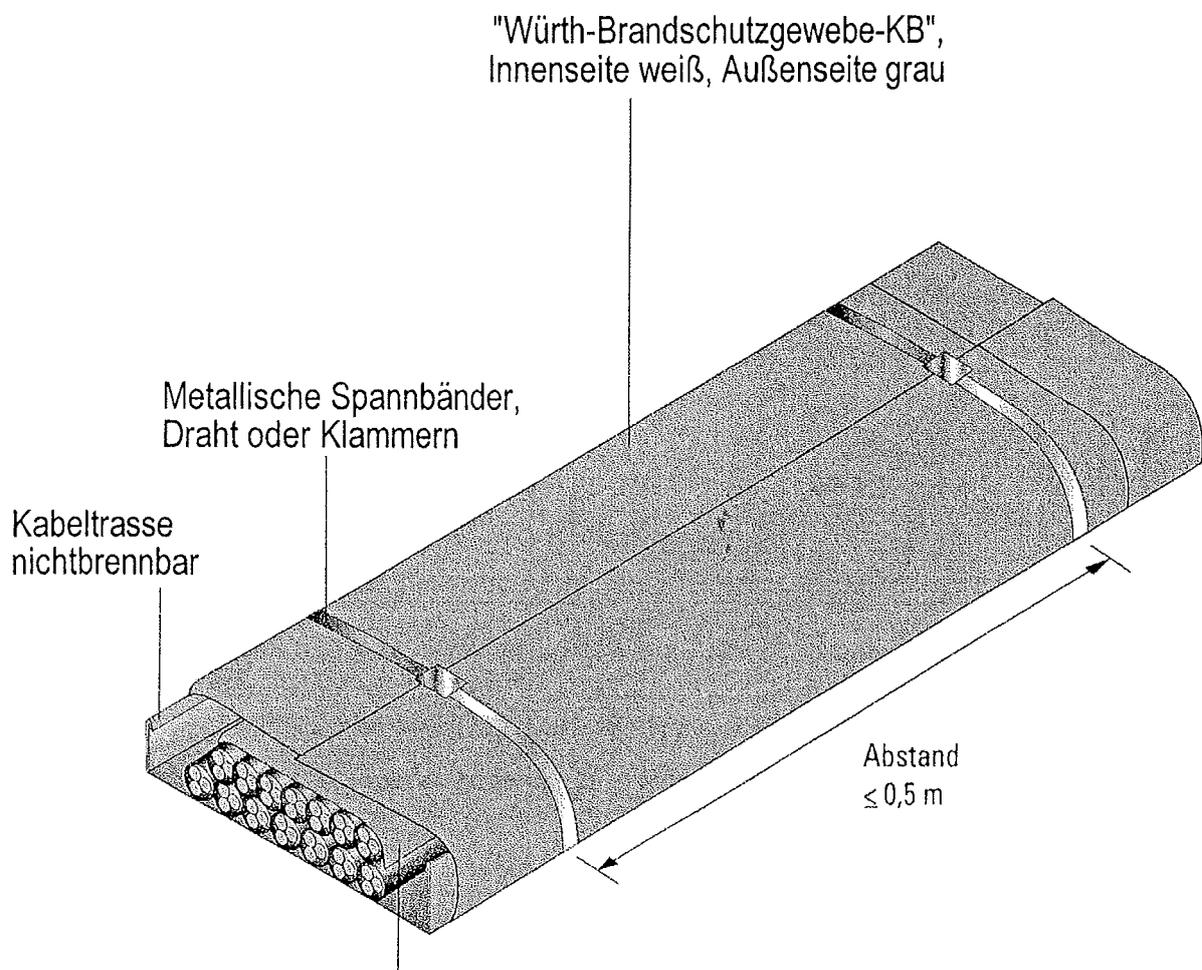
Zwischenlage als Abdeckung der oberen Kabellage:
