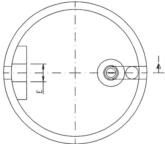
Probenahmeschacht als Probenahmeverrichtung gemäß DIN 1999-100
