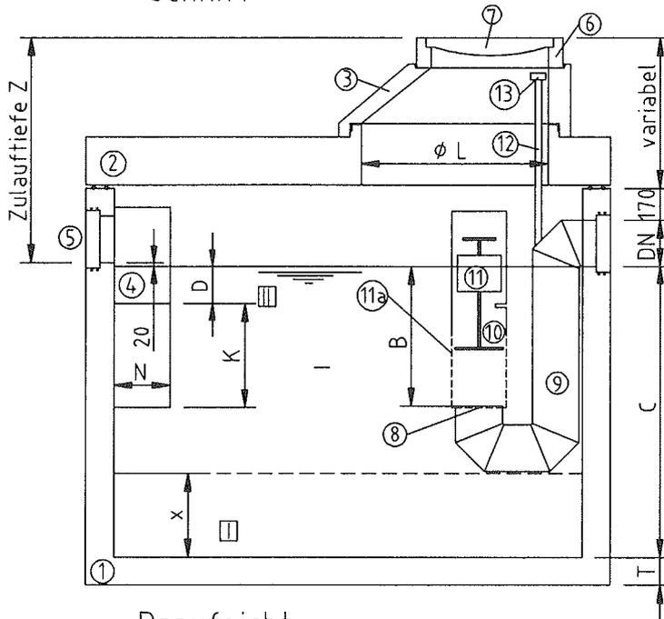
Schachtaufbau nach DIN EN 1917
