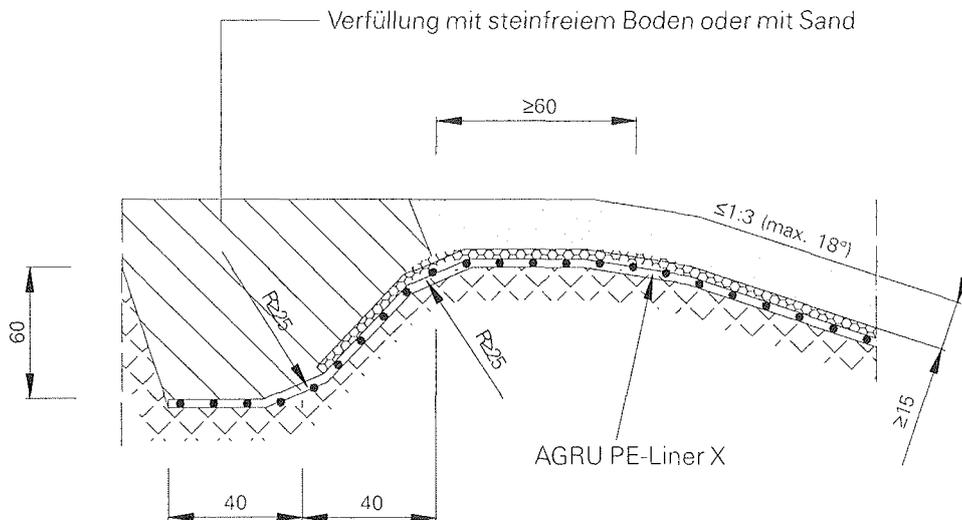
Ausrundungsradien der AGRU PE Liner X:  $r > 0,25\text{m}$
