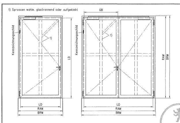
Dargestellt: Gangflügel DIN links Gangfügel DIN rechts spiegelbildlich T30-1-RS-Tür und T30-2-RS-Tür immer mit absenkbarer Bodendichtung ausführen und bei Wandanschluss immer beidseitig versiegeln!
