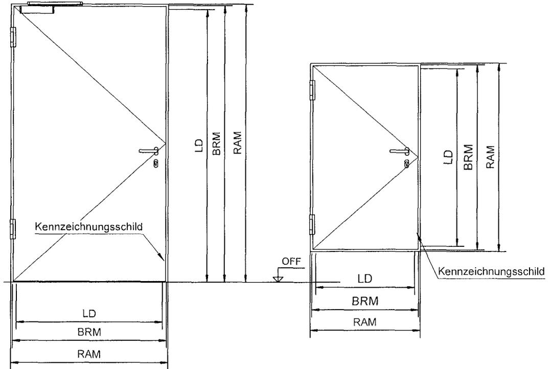
T30-1-RS-FSA immer mit unterer Bodendichtung ausführen und bei Wandanschluss immer beidseitig versiegeln!
