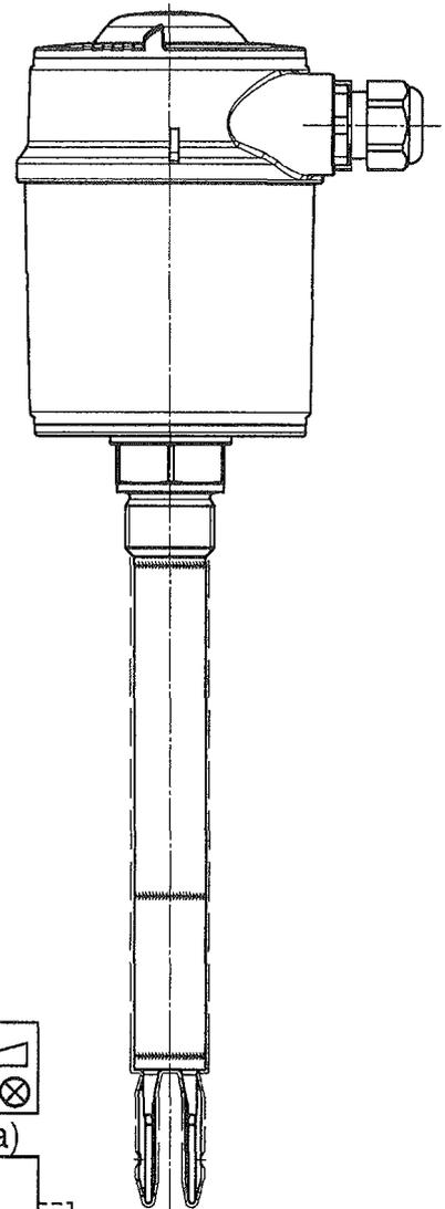
**Schema der Überfüllsicherung**
