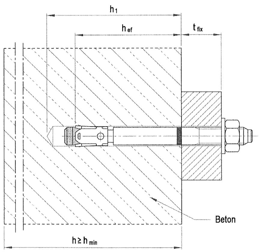
**Halben Bolzenanker HB-BZ**
