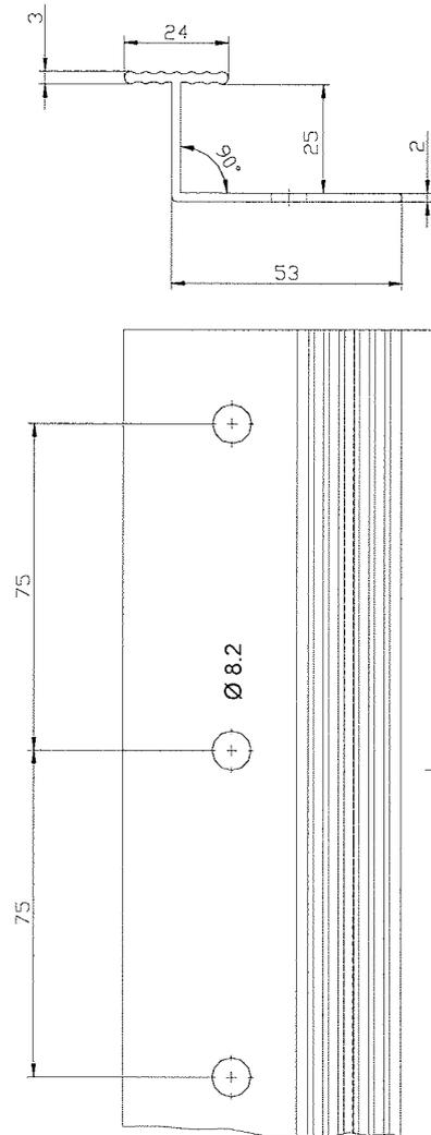
**Vertikales Verbindungsprofil – "HECK Verbindungsschiene PVC" (Maße in mm)**
