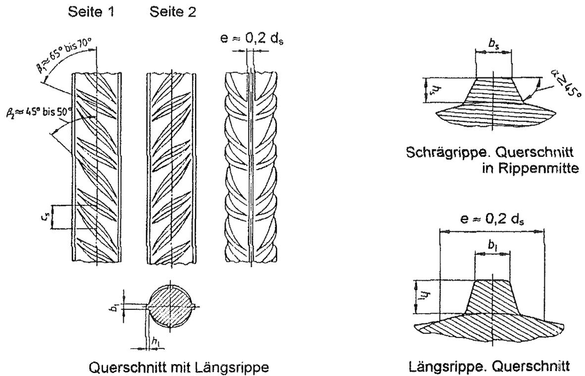
Für die Längsrippen gilt DIN 488-2:1986-06, Abschnitt 4.2.3
