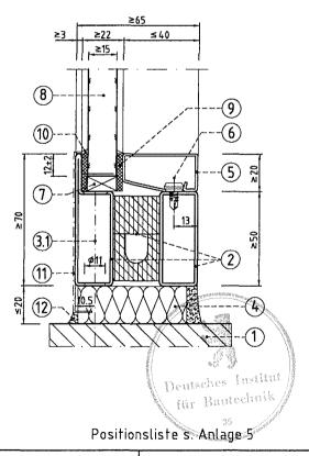
Brandschutzverglasung "PYRANOVA® System 5-F30" der Feuerwiderstandsklasse F 30 nach DIN 4102-13
