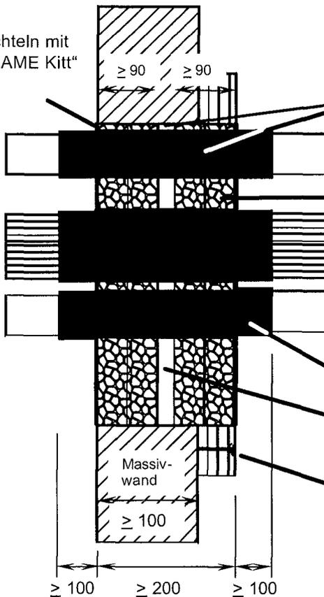
Beschichtung aller Kabel und Kabeltragekonstruktionen im Innern der Abschottung sowie der Laibungen mit „ISO-FLAME Kitt“;
