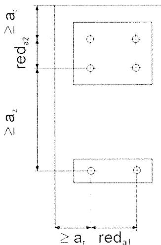
Reduziert zulässige Lasten bei reduzierten Achsabständen je Dübel bei Dübelgruppen  $a \geq \text{red } a > \text{min } a$  (siehe Abschnitt 3.2.2)
