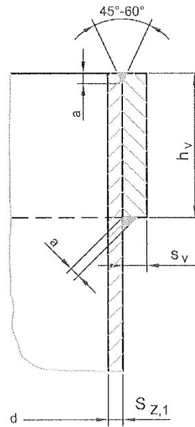
Die Randverstärkung darf auch an der Zylinderinnenfläche angebracht werden.
