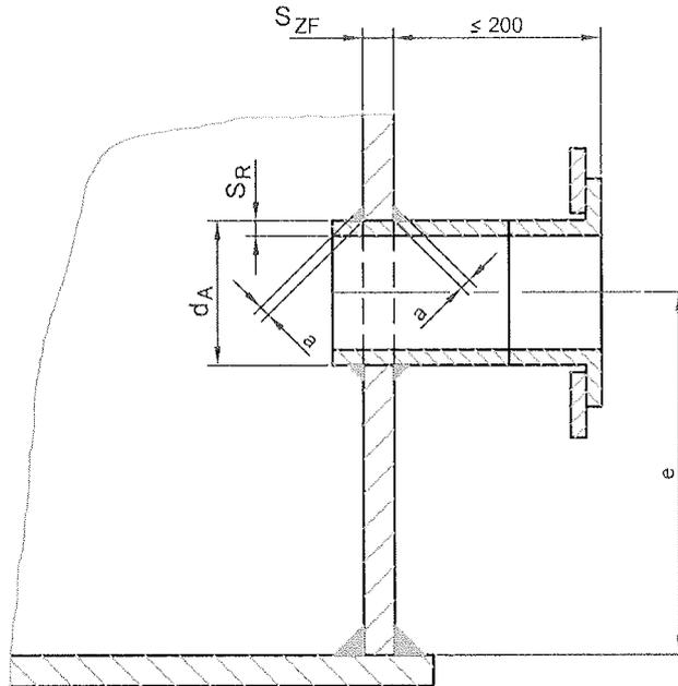
$$a \geq 0,7 \cdot \min(S_{ZF}, S_R) \quad (\text{WE, WZ})$$
