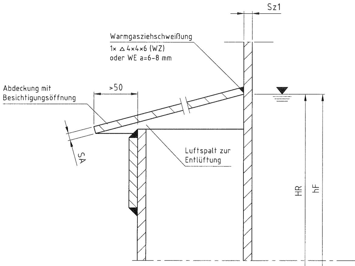
Befestigung des Regenabweisers in Abhängigkeit von hF:
