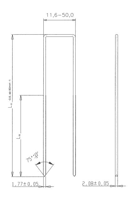
Klammerrohdraht: verzinkter runder Stahldraht ø 2,00±0,03mm Zugfestigkeit ≥ 900 N/mm<sup>2</sup>
