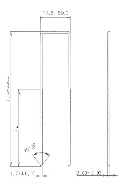
Klammerrohdraht: nichtrostender runder Stahldraht ø 2,00±0,03mm Zugfestigkeit ≥ 900 N/mm<sup>2</sup> Harzung  $L_H = mind. 0,5 L_n$ ;  $\geq 25mm$  WNr. 1.4301 / 1.4401 oder 1.4529 Schaftlänge  $L_n = 35,0 - 130,0mm$
