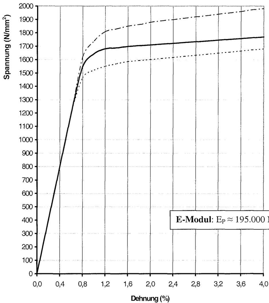
**Bild 1:** Spannung-Dehnungs Linie; die gestrichelten Linien zeigen die Grenzen an, innerhalb der die Linie verlaufen muss.
