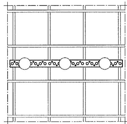
Betondeckung  $c_u$  und  $c_o$  nach DIN 1045-1:2008-08, Abschnitt 6.3
