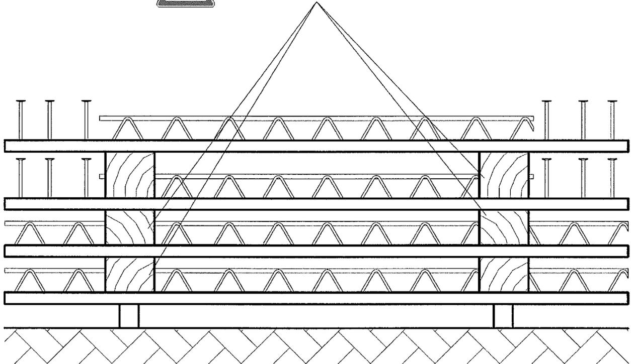
Beim Lagern und Transportieren von Elementdecken sind die HDB-G-S - Schubbewehrungen zu beachten, die aufgrund ihrer Höhe über die Gitterträger hinausragen. Die zur Auflagerung der Elementdecken erforderlichen Distanzhalter sind entsprechend zu erhöhen.
