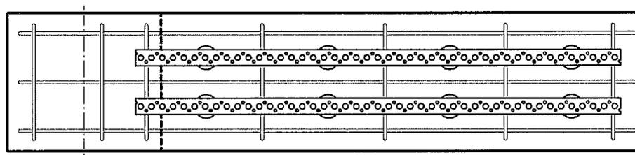
Zur Aufnahme von Querkzugkräften sollte mindestens ein Bügel zwischen zwei HDB-Ankerpaaren angeordnet werden.
