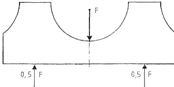
**Bild 2:** Belastungsanordnung Zugversuch
