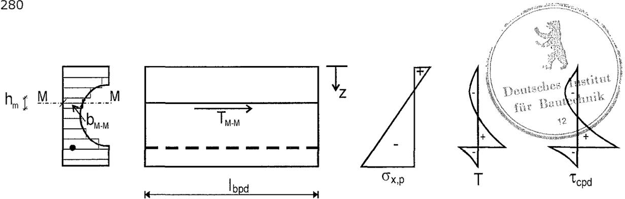
**Bild 1:** Ermittlung der Schubspannung aus Spannkrafteinleitung
