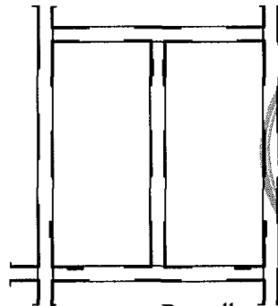
Darstellung: Lage der besonderen Unterklötzung bei L-Anschluss (Positionsliste siehe Anl. 18 - 20)
