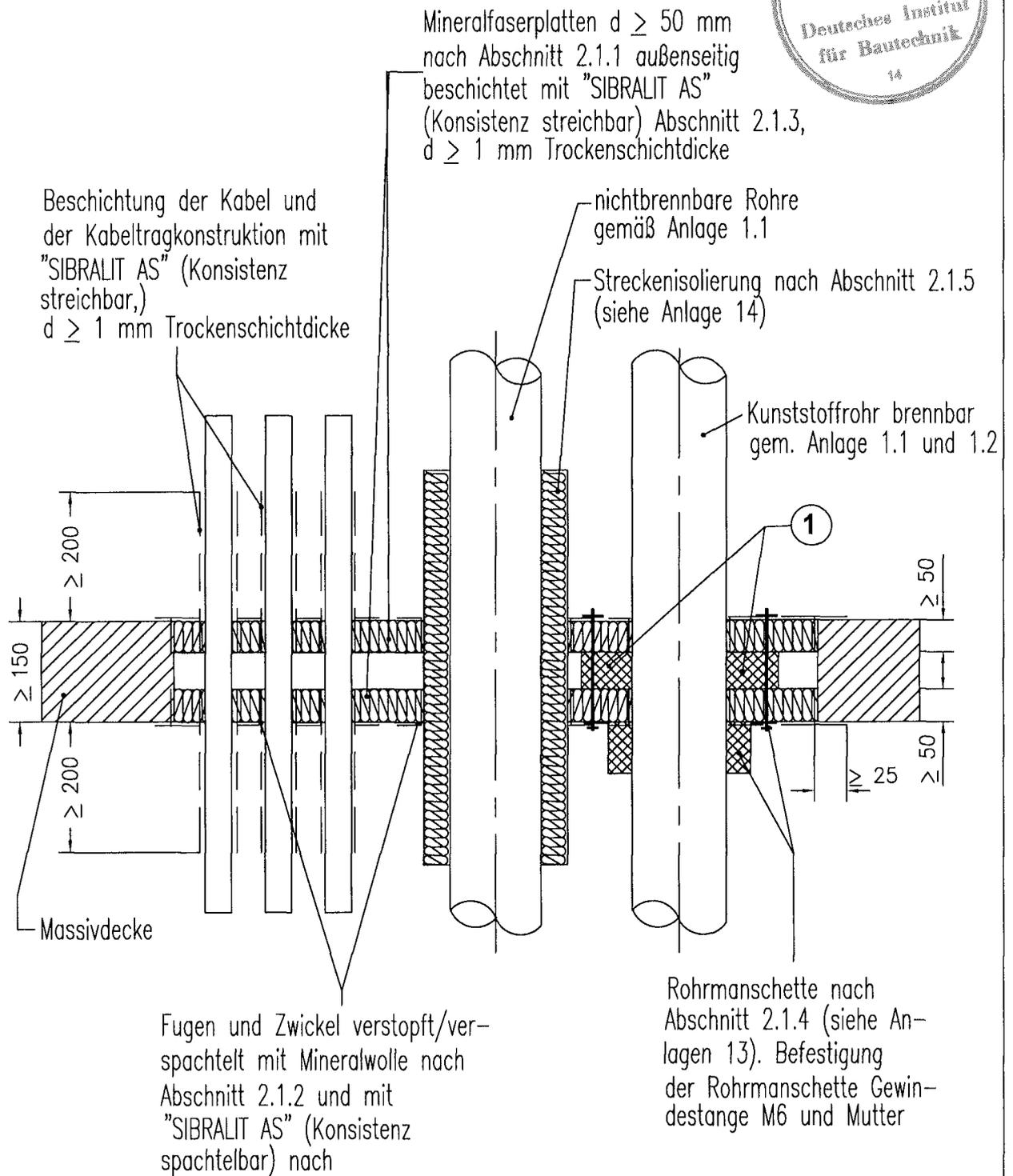
① Bei Durchführung von brennbaren Rohren auf einer Breite von  $> 50$  mm mit Streifen aus Mineralfaserplatten nach Abschnitt 2.1.1 vollständig ausfüllen
