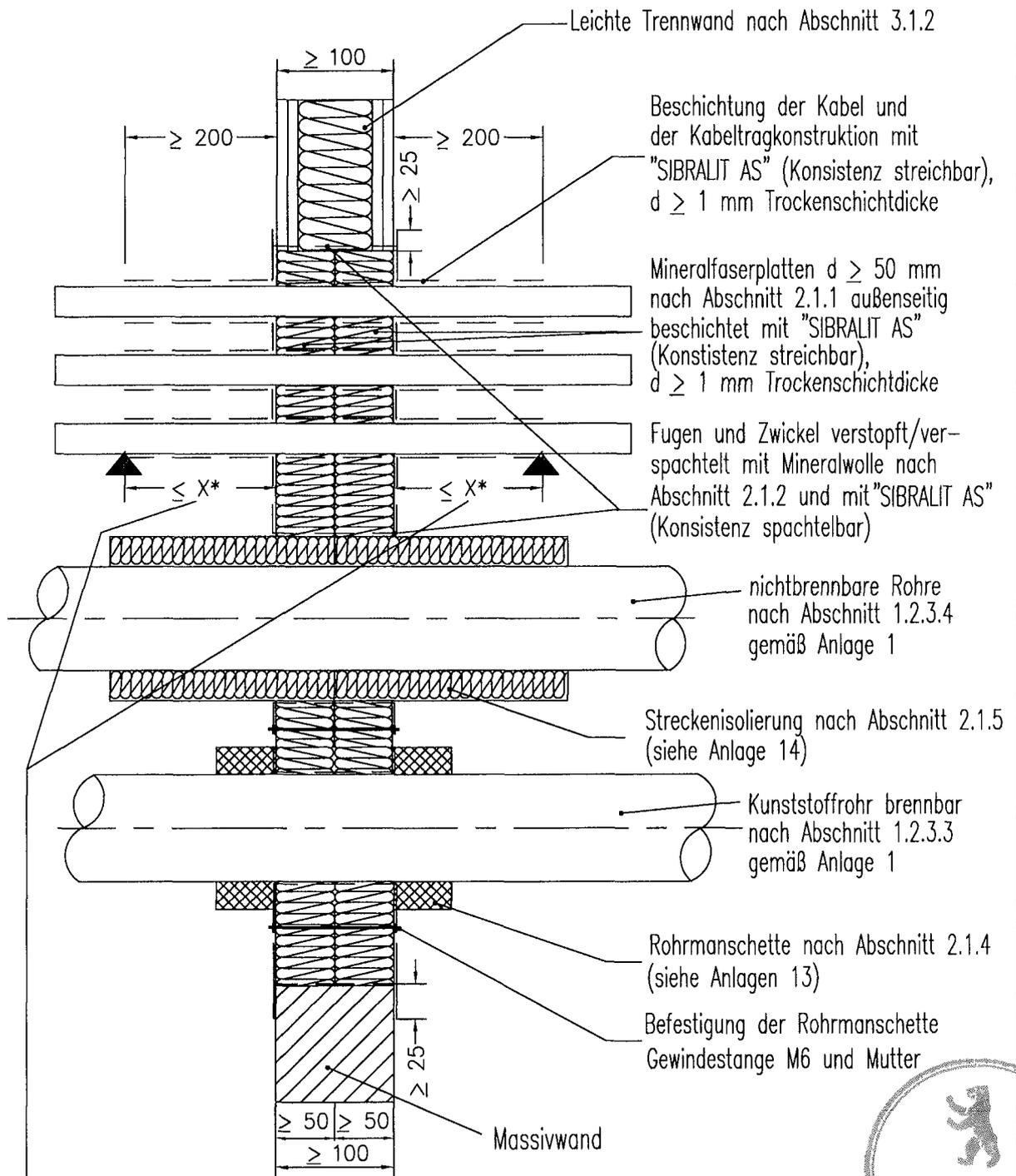
Erste Unterstützung der Kabel und Kabeltragkonstruktionen:
