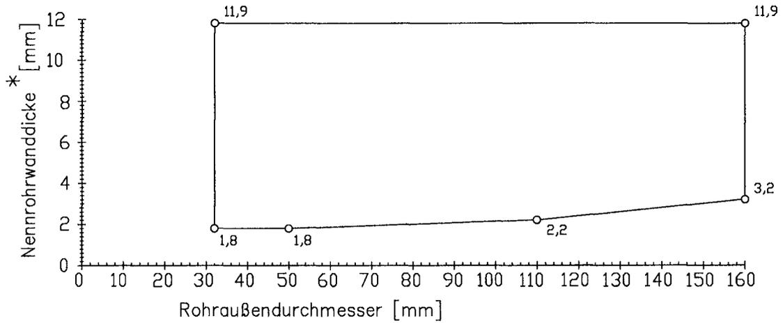
Rohre gemäß Rohrgruppe B der Anlage 1.1 für Einbau der Kombiabschottung in Massivwände und -decken bzw. leichte Trennwände nach Abschnitt 3.1.2
