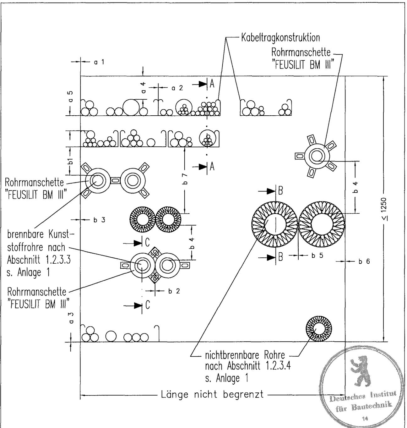
Maximale Abmessungen der Abschottung:
