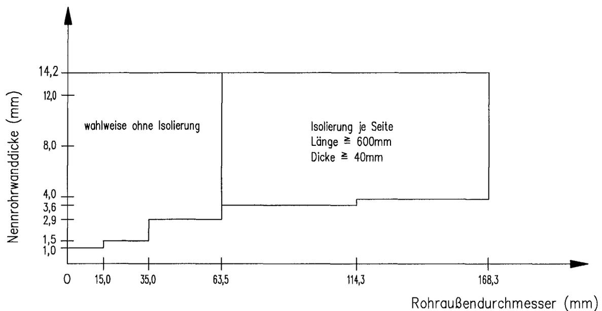
Zulässige Rohre aus Kupfer mit Isolierung aus Mineralfaserprodukten gemäß Abschnitt 2.1.4.1
