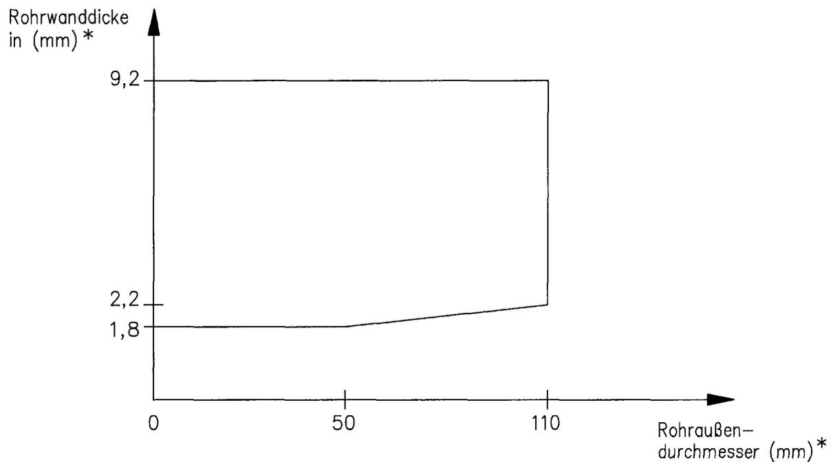
zulässige Rohre gemäß Anlage 16, Ziffer 8-22: PE-HD, PE-LD, PP, ABS, ASA, PE-X, PB, PS
