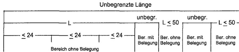
Einlage eines Glasgewebestreifens über die gesamte Schottbreite und -dicke
