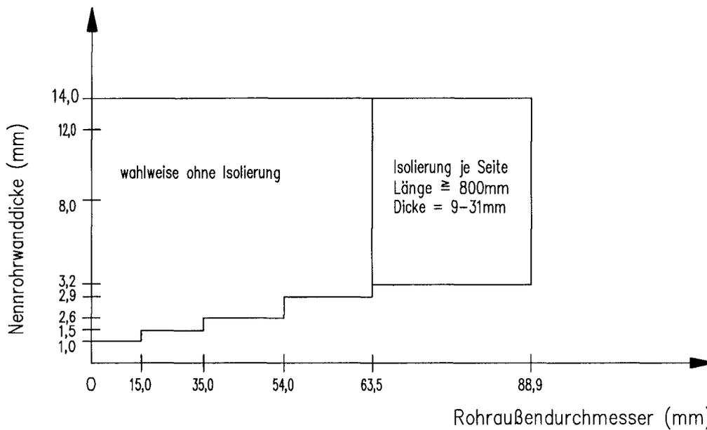
Zulässige Kupferrohre mit Isolierungen aus synthetischem Kautschuk, gemäß Abschnitt 2.1.4.2
