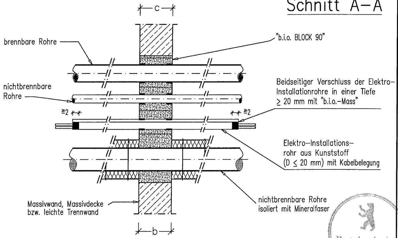
Kabelabschottung "DASTILIT Block-Kombi S90" der Feuerwiderstandsklasse S90 nach DIN 4102-9
