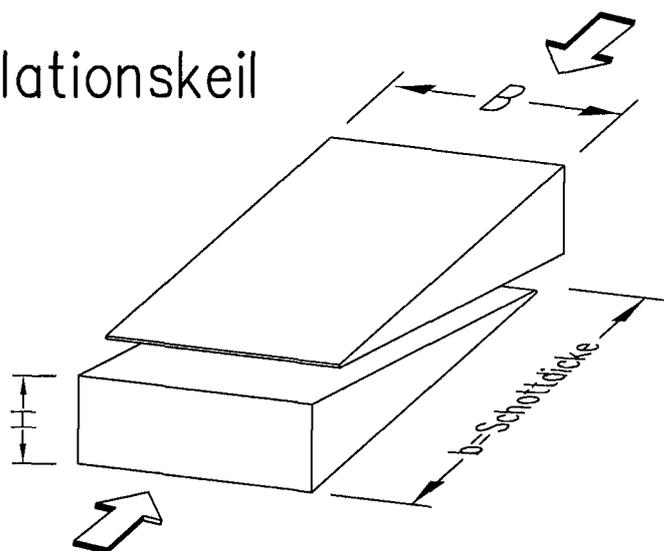
Der Nachinstallationskeil vereinfacht in schwierigen Einbaulagen das nachträgliche Öffnen der Kabelabschottung. Die mit den Nachinstallationskeilen belegte Schottfläche darf eine Größe (BxH) 30x15cm nicht überschreiten.
