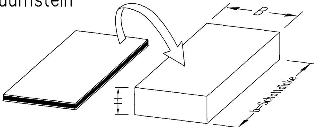
Der Vakuumstein wird in Restspalte eingefügt und verschließt diese nach Öffnen der Folie.
