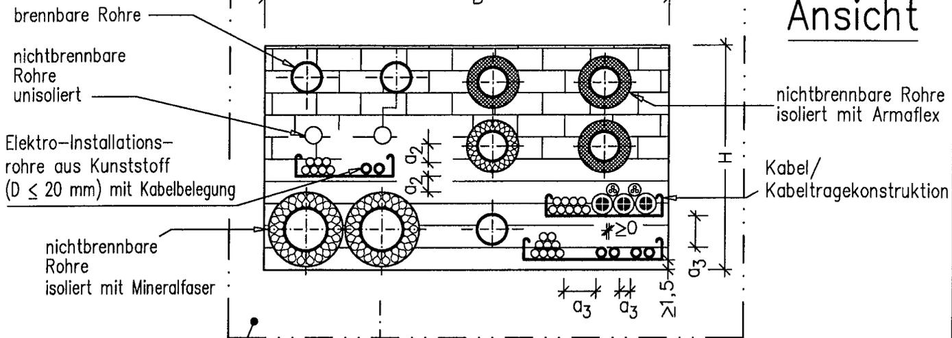
Es gelten alle Bedingungen für den Einbau in Massivwände, Massivdecken und leichte Trennwände gemäß Anlagen 1 bis 7
