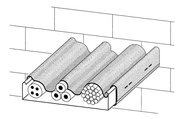
Kabel Ø > 18 mm, Kabelbündel, Steuerleitungen aus Stahl und die zugehörigen Kabeltragekonstruktionen in S90 / S60 -Abschottungen müssen profilfolgend auf beiden Seiten der Kabelabschottung auf einer Länge von 15 cm mit Streifen aus dem dämmschichtbildenden Baustoff, "Kabelwickel FBA-WI" genannt, umwickelt werden.
