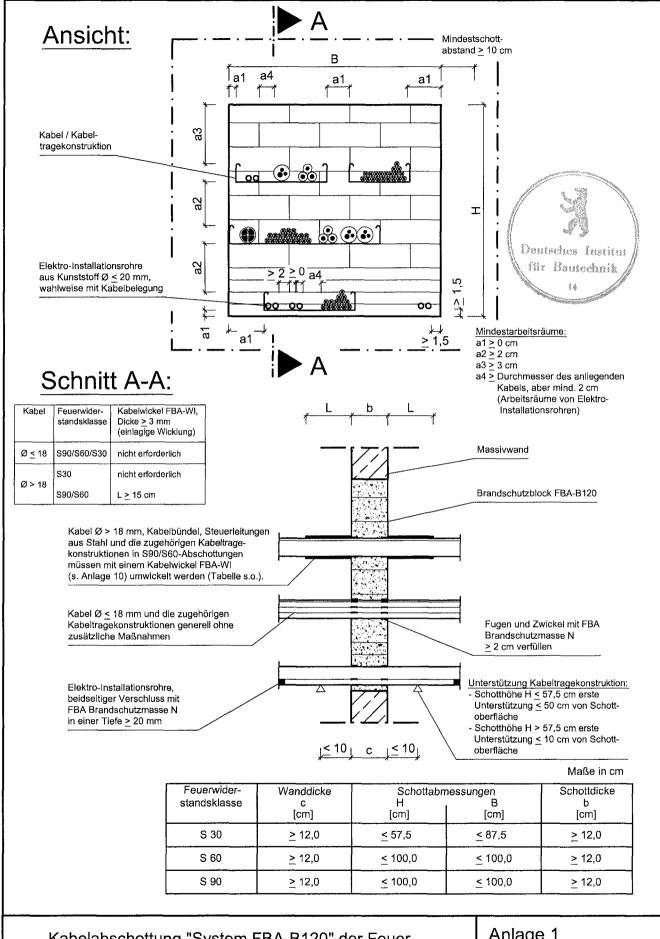
Kabelabschottung "System FBA-B120" der Feuerwiderstandsklasse S90, S60 bzw. S30 nach DIN 4102-9
