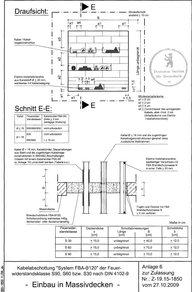
Kabelabschottung "System FBA-B120" der Feuerwiderstandsklasse S90, S60 bzw. S30 nach DIN 4102-9
