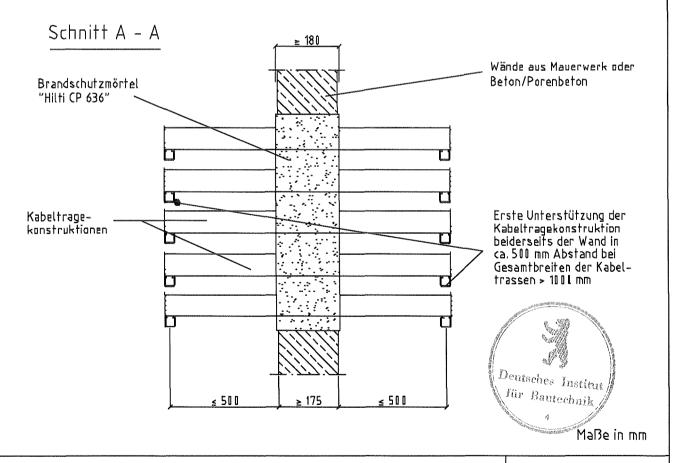
Kabelabschottung "Hilti Brandschutz-System CP 636-S 120" der Feuerwiderstandsklasse S 120 nach DIN 4102-9
