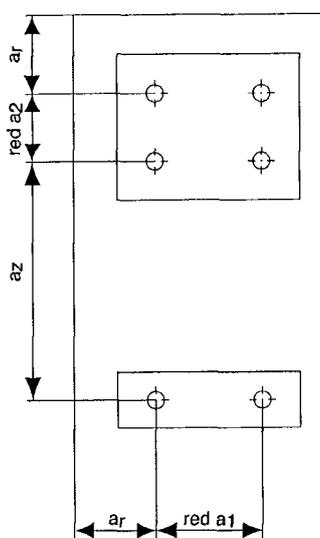
Reduzierte zulässige Lasten bei reduzierten Achsabständen je Dübel bei Dübelgruppen
