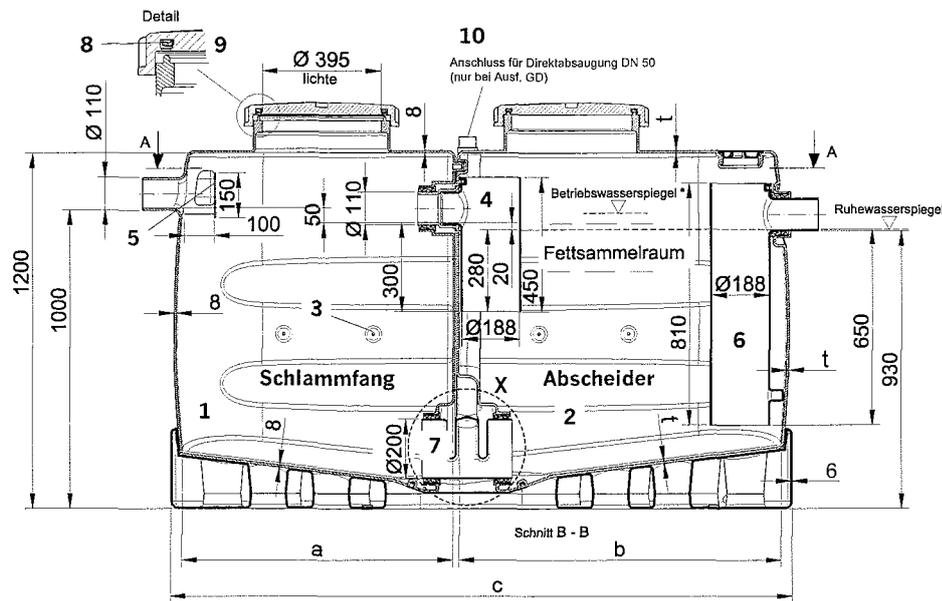
Einzelheit X -Verbindungsrohr-
