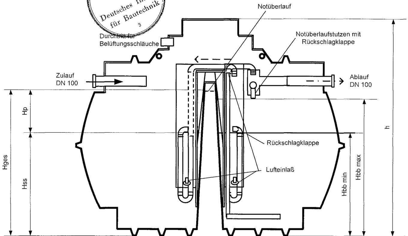
Herstellung: Rotationssinterverfahren; Werkstoff: PE
