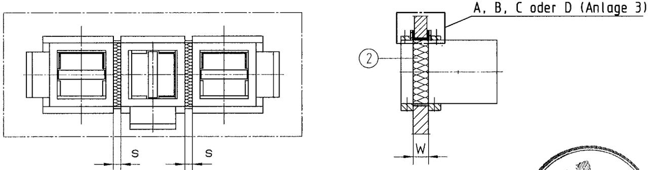
Bei Einbau in massive Wände mit Mineralwolle müssen die Entrauchungskappen mit Abhängungen entsprechend DIN 4102-4 versehen sein.
