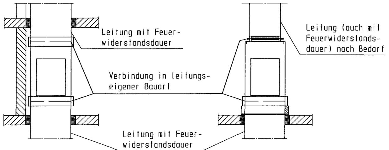
Deckendurchbruch und Lastabhängung nach dem allgemeinen bauaufsichtlichen Prüfzeugnis der Entrauchungsleitungen.
