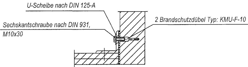
Die Befestigung der ERK-T-K erfolgt gemäß der Anzahl der Befestigungswinkel WE, wie in den Herstellerunterlagen dargestellt. Bei Befestigungswinkeln WE müssen 2 Brandschutzdübel des Typs KMU-F-10 verwendet werden. Die Befestigungswinkel WE müssen wie in den Zeichnungen dargestellt oben und unten angebracht sein.
