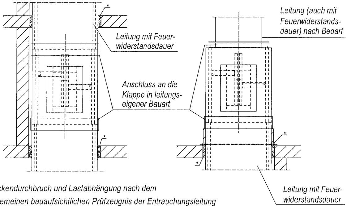
\* Deckendurchbruch und Lastabhängung nach dem allgemeinen bauaufsichtlichen Prüfzeugnis der Entrauchungsleitung
