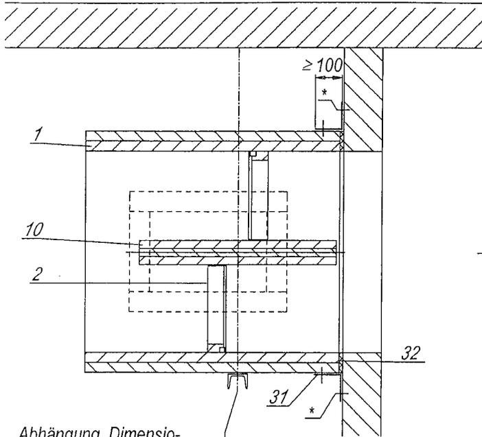
Abhängung, Dimensionierung nach DIN 4102-4
