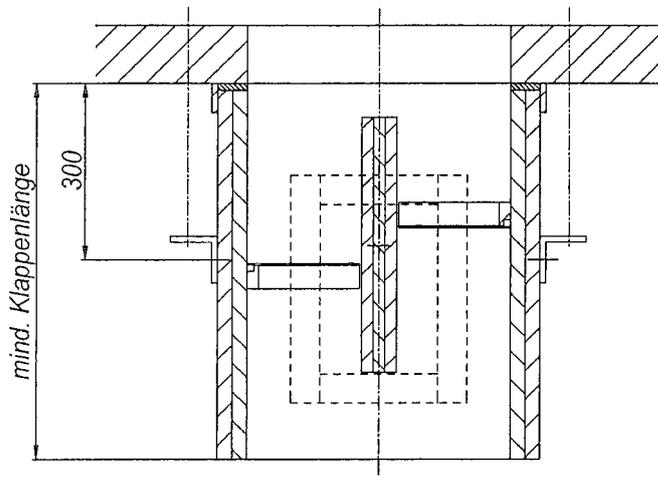
Darstellung des Anschlußprofils für Entrauchungsleitung 600° (Stahlblech)
