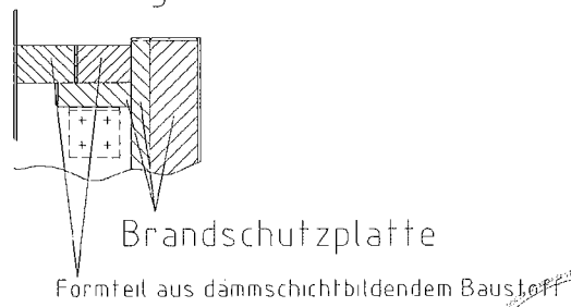
Kabeleinführung Detail Y 3
