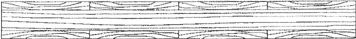
**Schematischer Aufbau der Dreischichtplatten "MHP – UGL – 3S geschlitzt"**
