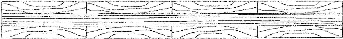
**Schematischer Aufbau der Dreischichtplatten "MHP – UGL – 3S normal"**
