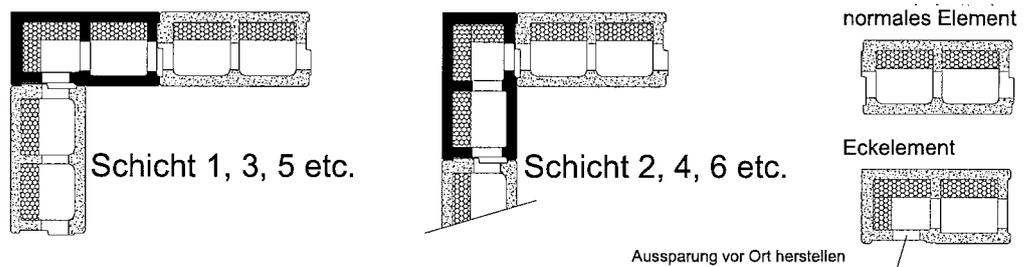
Schichtaufbau in der Wandecke – alle Typen mit einer Dicke von 30 cm
