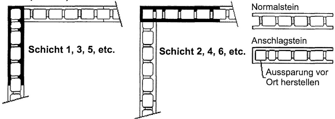
**Schichtaufbau in der Wandecke – Typen TW 30, TW 32, TW 35**
