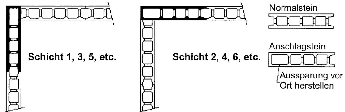
**Schichtaufbau in der Wandecke – Typen S 25/6, S 30/10, S 32/11, S 30/7, S 30/8 S 38/16, S 38/19**
