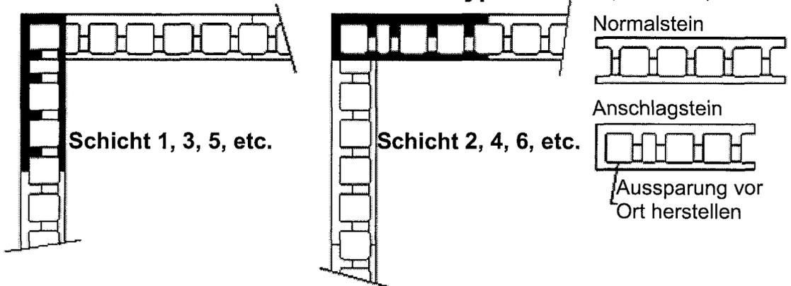
**Schichtaufbau in der Wandecke – Typen S 25/6; S 30/5; S 30/7; S 30/9; S 36,5/16,5; S 36,5/13,5; S 36,5/10,5; S 36,5/5**
