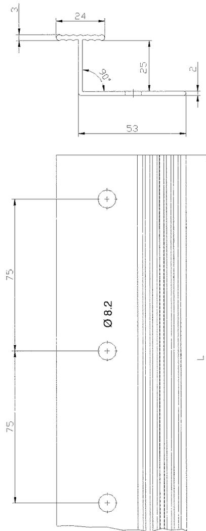
**Vertikales Verbindungsprofil – "PVC Verbindungsleiste" (Maße in mm)**
