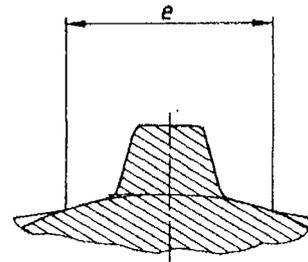
Querschnitt mit Längsrippe <sup>6)</sup>
