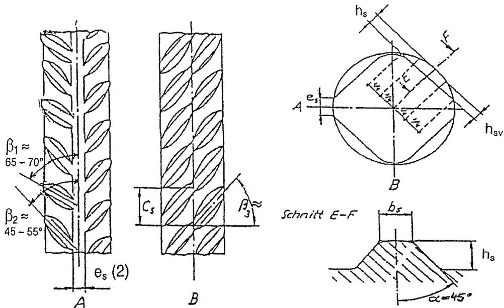
Tabelle 3: **Abmessungen, Querschnittsfläche, Gewicht und Rippengeometrie - Wechselnd geneigte Rippen -**
